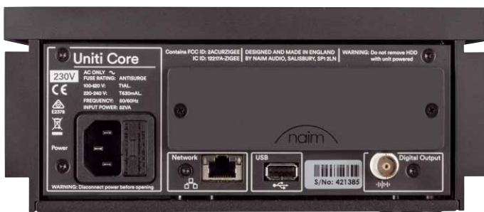
Hinter der angeschraubten Abdeckung verbirgt sich die Schublade für die genutzte Festplatte. Der BNC-Anschluss kann mit einem Adapter auf Koax umgerüstet werden
