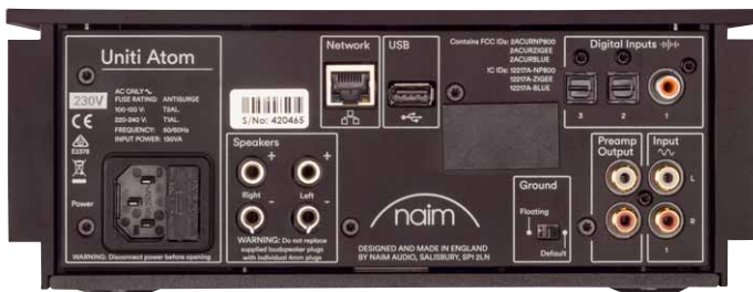
Der Atom gibt seine Leistung ausschließlich an Bananen- und Hohlstecker ab, um auf der engen Rückseite Platz zu sparen
