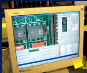
◀ „Super Vision“ prüft die Bestückung der Platinen inklusive der Einpassung aller Teile
