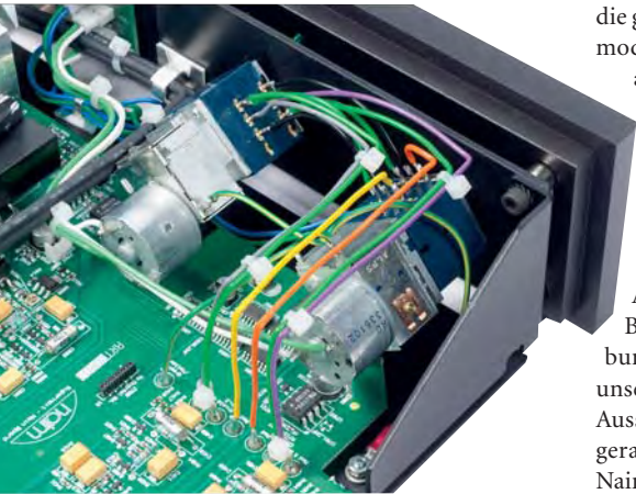
Nicht nur das präzise Lautstärkepotentiometer ist mit einem Motor versehen, auch die Balance lässt sich per Fernbedienung motorisch steuern
