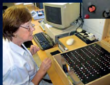
▶ Um nichts dem Zufall zu überlassen, werden auf diesem Board Transistoren per Computerprogramm geprüft und selektiert
