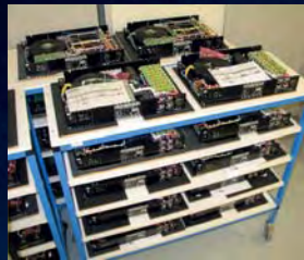
◀ Kein Gerät verlässt die Insel ohne Dauertest. Er währt zwei Tage, im Falle von CD-Playern sogar drei
