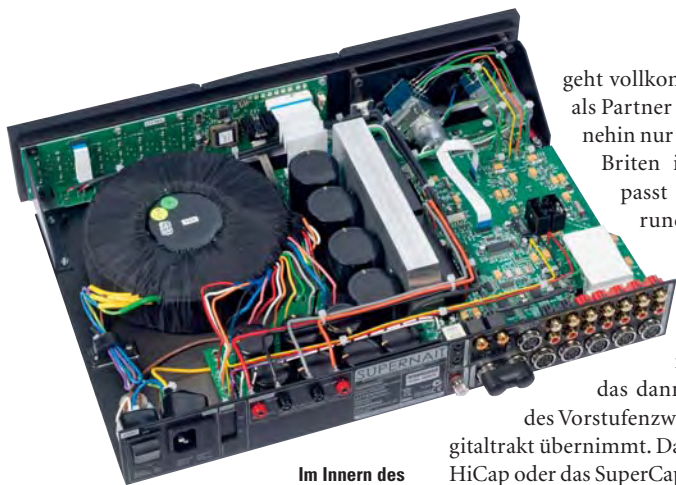
Im Innern des SuperNait sind das Eingangsteil nebst Digitalplatine weit von etwaigen Störungen des fetten Netzteils (L.) entfernt
