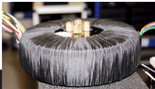
▲ Ein Trafo für Gewichtheber und Leistungsfetischisten, der mit vier massiven Schrauben fixiert wird – Leistung: rund vier KVA.
