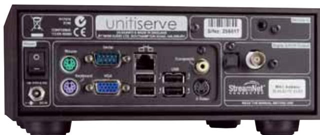
Über die USB-Schnittstellen ist der UniServe erweiterbar. Per Digital-out und einem iPod als Steuergerät fungiert er sogar als HDD-Player
