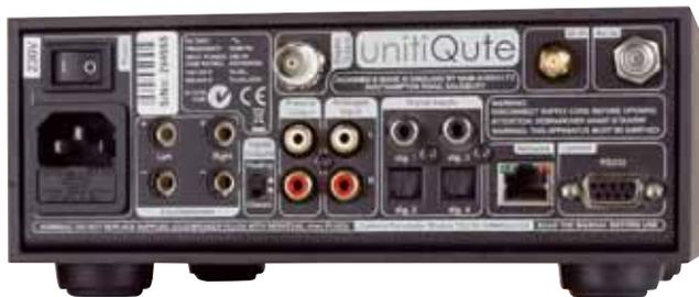
Der UnitiQute dient als Schaltzentrale für viele analoge und digitale Quellen. Für die Lautsprecher bieten sich Bananas an
