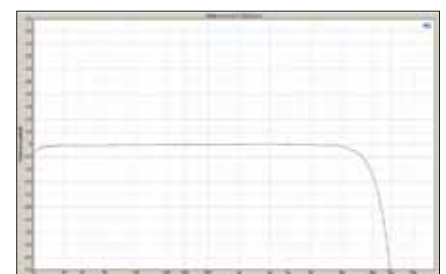
Der gesamte Übertragungsbereich fällt bei 25 kHz schon auf -3 dB ab, das ist kein Problem
