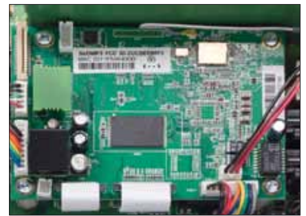
Über die Netzwerkplatine gelangen Wi-Fi- und LAN-Signale in den UnitiQute
