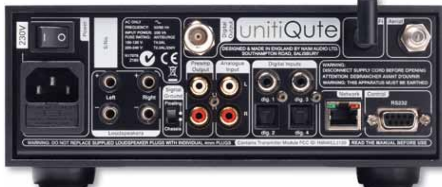
Der UnitiQute ist ein Paradebeispiel für einen Netzwerkreceiver: Digitale sowie analoge Ein- und Ausgänge werden von den Lautsprecheranschlüssen konsequent abgerundet
