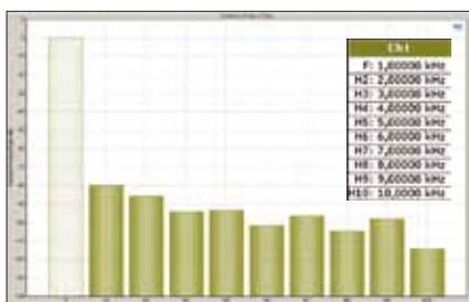
Das Verzerrungsproduktverhältnis ist unter Last relativ ausgeglichen auf geringem Niveau
