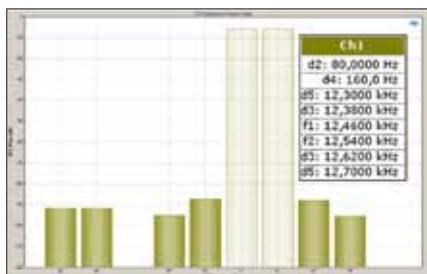
Differenztonverzerrungen werden vom Qute, dank des Schaltungsdesigns sehr gut unterdrückt
