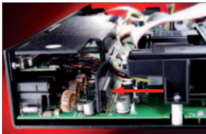
Digitale Kraft: Mit den Tripath Power-ICs (Pfeil) gibt der Naim Audio n-Vi eine für DVD-Receiver sensationelle Leistung an die Lautsprecher ab.
