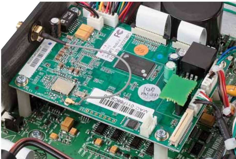
Kaum größer als eine Handfläche: Naims Streamingboard wurde gegenüber den älteren Modellen im Layout massiv überarbeitet. Spannungsversorgung, Prozessoren (die liegen auf der Unterseite) und WLAN beeinflussen sich nun hörbar weniger.
