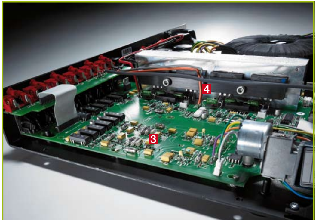
(1) Um den XS in eine Heimkino-Anlage zu integrieren, lässt sich über einen Schalter ein Eingang auf feste Verstärkung schalten. (2) Ein externes Netzteil kann über zwei DIN-Buchsen angeschlossen werden. (3) Die Vorstufensektion entstammt der NAC 202 (12/02) und ist wie die Endstufe (4) mit dem Supernait identisch (12/02).
