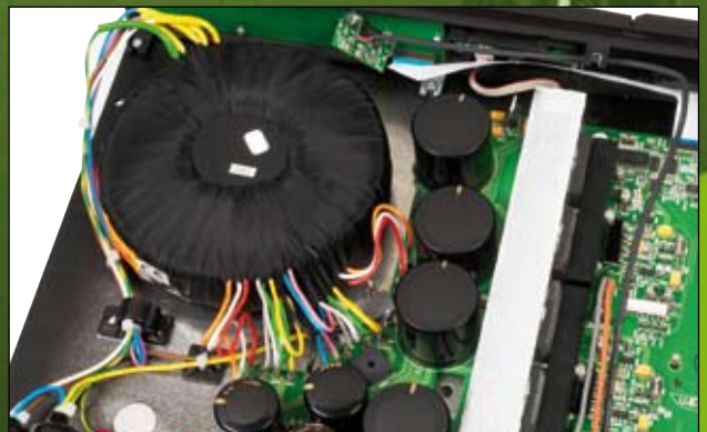
Eine satte Stromversorgung ist bei Naim Tradition. Ganz nach dem Motto: Verstärker sind frequenzmodulierte Netzteile.
