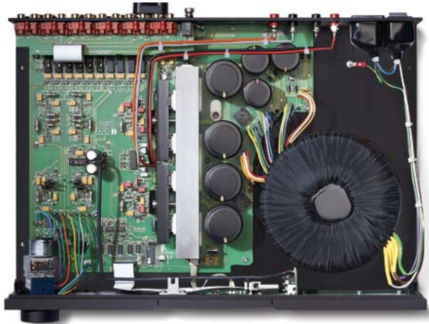
IN XS: Hochwertige Bauteile an entscheidender Stelle, keramische Isolatoren für die Kühlkörper und starke Endstufen machen den XS 2 aus.
