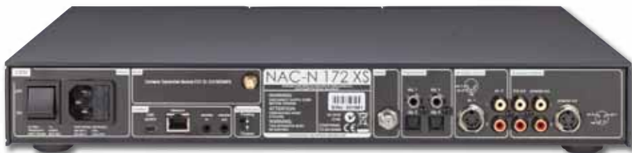
LAN- und WLAN-Streamer, D/A-Wandler sowie Analogvorstufe: Das Anschlussfeld der NAC-N ist nicht eben überfrachtet, wegen ihrer weit gefächerten Fähigkeiten aber trotzdem vielseitig bestückt
