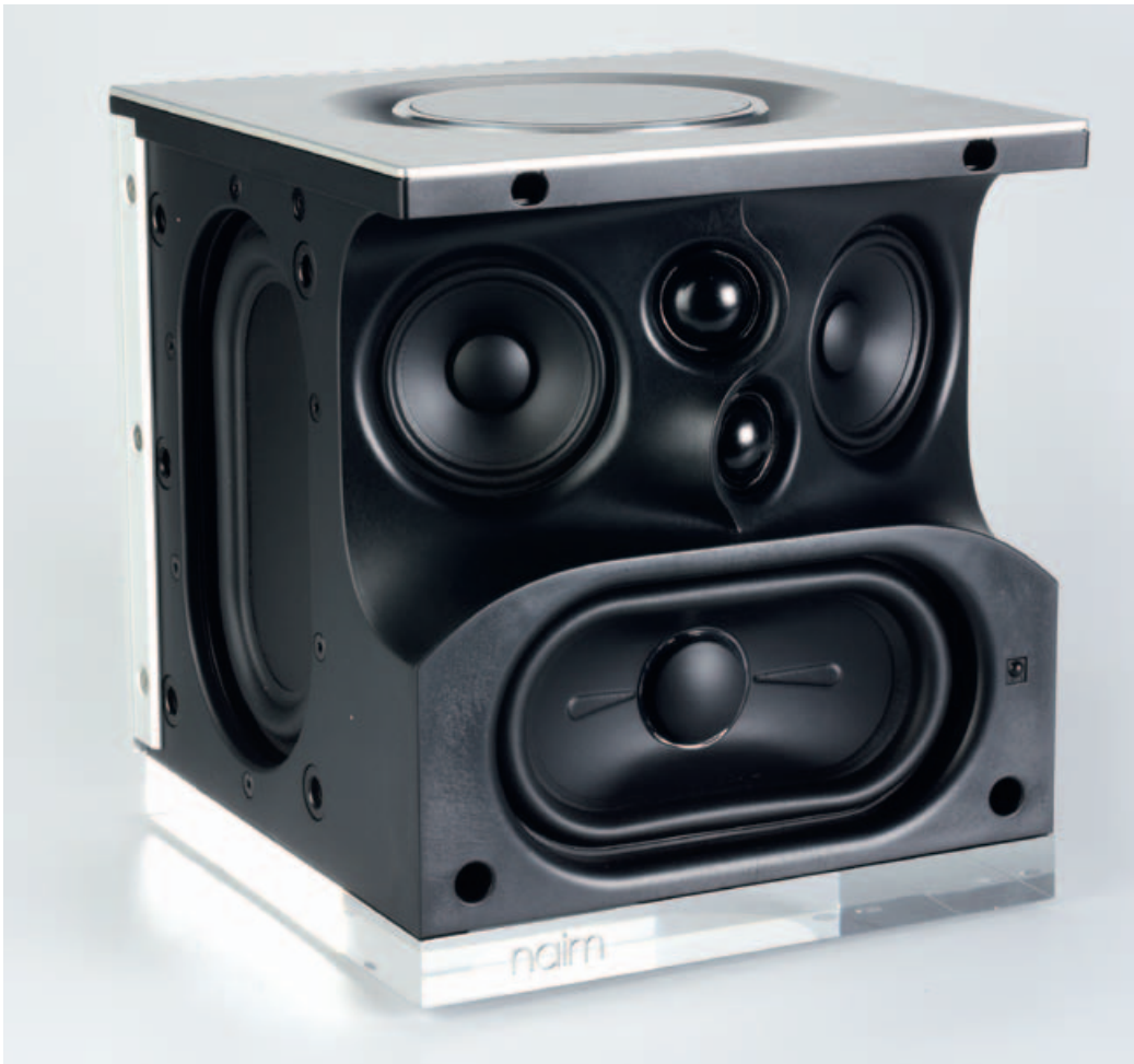
Naim hat seinen Würfel mit Lautsprechern vollgepackt. Die zentralen 2,5-cm-Kalotten-Hochtöner und die 6,4-cm-Mitteltöner sind voneinander abgewinkelt für eine breitere Bühne. Der ovale Front-Bass bekommt Unterstützung durch seitliche Passiv-Radiatoren. Den Antrieb liefert eine 300-Watt-Schaltendstufe.
