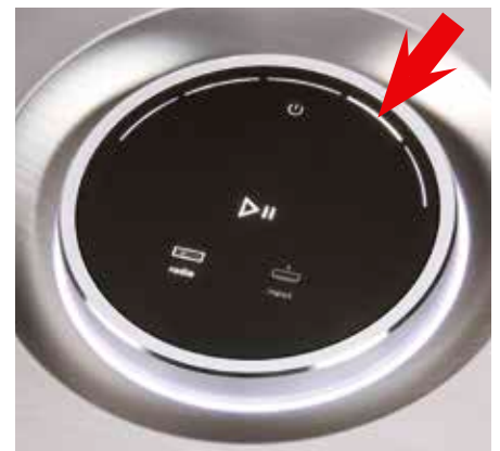
Das „Auge“ der Mu-So ist ein sensorisches Bedienfeld. Der Ring außenrum dient als Pegelsteller. Am Leuchten (Pfeil) können Sie ablesen, dass Radio-Preset vier gewählt ist.
