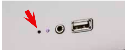
Unter dem Boden (links) liegen Strom, LAN und optischer Eingang. An der Gehäuseflanke (rechts) findet man zusätzlich einen USB- und analogen Miniklinkenanschluss. Das kleine Löchlein (Pfeil) und die Lampe daneben dienen dem WLAN-Setup oder zum Zurücksetzen der Mu-So.
