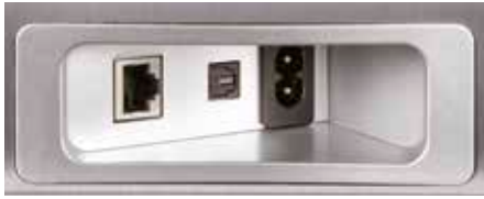
Unter dem Boden (links) liegen Strom, LAN und optischer Eingang. An der Gehäuseflanke (rechts) findet man zusätzlich einen USB- und analogen Miniklinkenanschluss. Das kleine Löchlein (Pfeil) und die Lampe daneben dienen dem WLAN-Setup oder zum Zurücksetzen der Mu-So.
