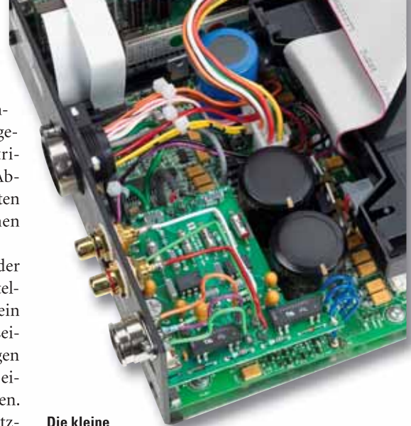
Die kleine Wandlerplatine im Vordergrund hat gewichtigen Anteil am vorzüglichen Klang des Musik-Servers
