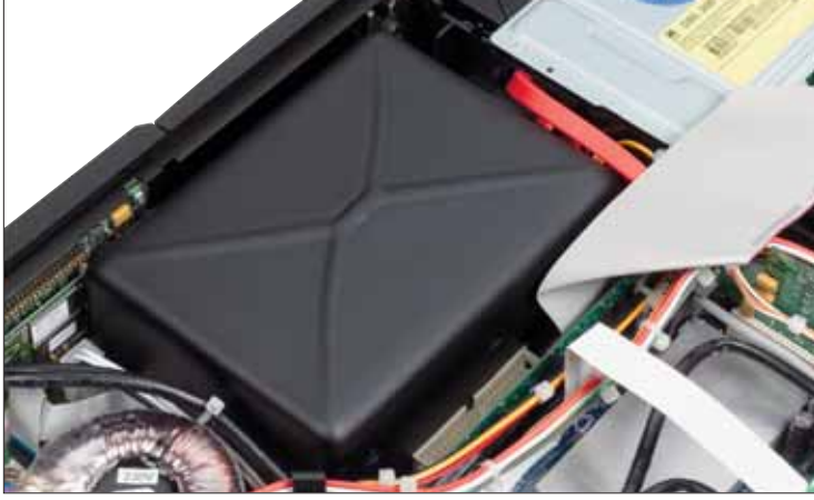
Die Festplatten des HDX (der schwarze Block in der Bildmitte) sind durch ihren „Gummi-Mantel“ nicht nur elektrisch abgeschirmt, sondern auch mechanisch entkoppelt
