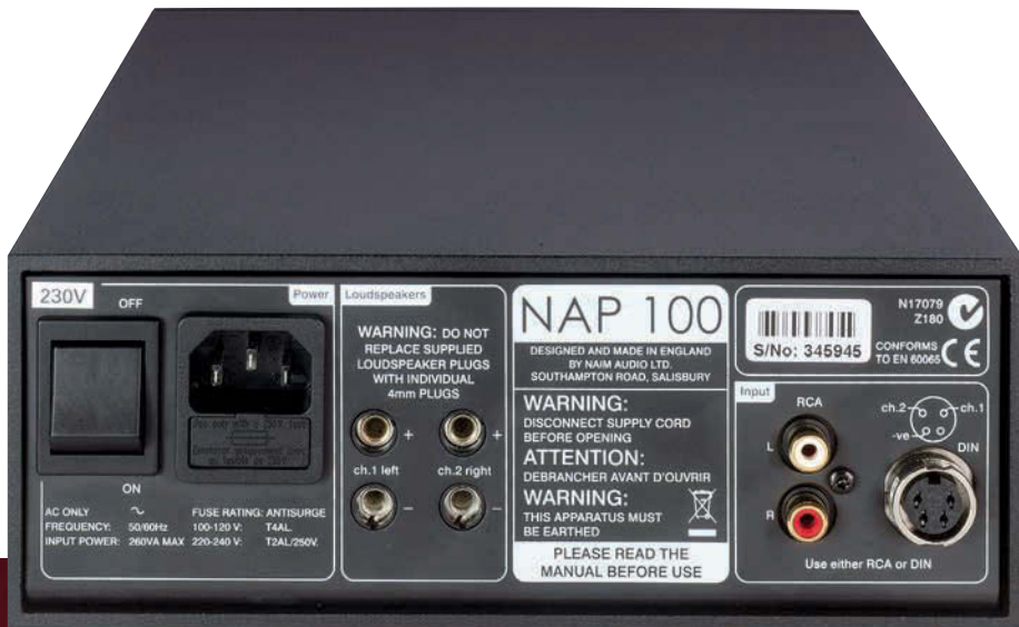
Nur für Bananenstecker: Die NAP100 bietet Cinch-Eingänge sowie einen DIN-Anschluss. Bei der Wahl der LS-Kabel sollte man die vertieften Buchsen bedenken
