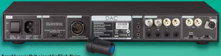
Anschlussvielfalt einschließlich Naim-typischem DIN-Ausgang (r.). Unter der Kappe (M.) verbirgt sich der Anschluss für ein externes Netzteil
