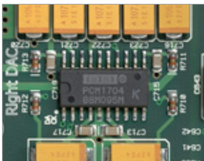
Ein ganz Großer unter den Wandlern: der PCM 1704 mit K-Zusatz, da selektiert
