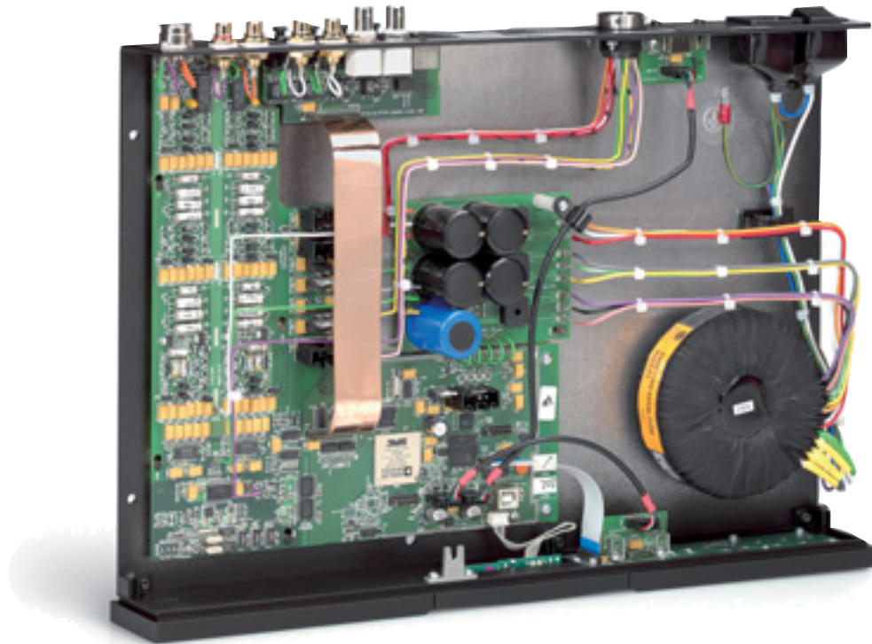
Der Ringkerntrafo bietet drei getrennte Wicklungen: für den DSP, die Takt-Schaltkreise und den ganzen Rest
