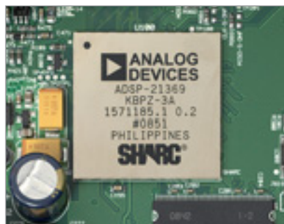
Auf dem schnellen DSP läuft Naim-Software zur Aufbereitung des Digitalsignals
