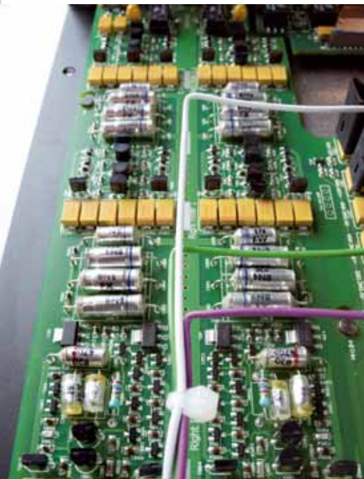
Die Ausgangsstufe des DAC ist diskret aufgebaut. Naim verwendet ein ungewöhnlich steiles Ausgangsfilter mit 36 Dezibel pro Oktave
