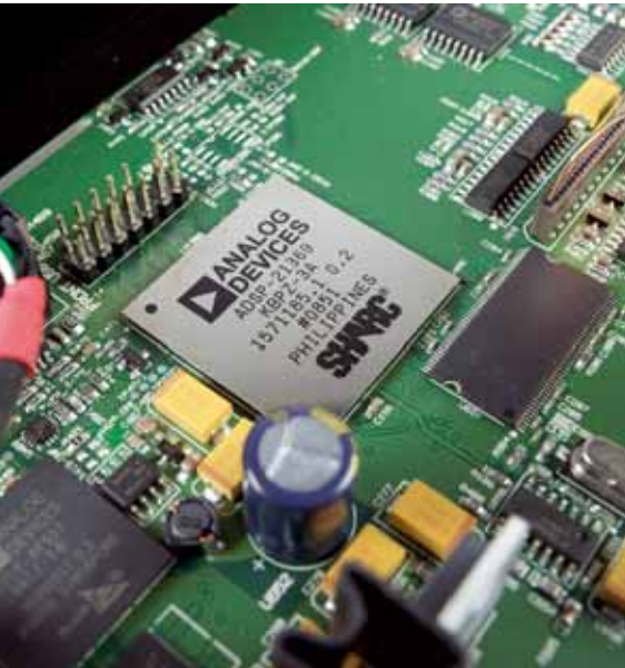
Da steckt der Grips drin: Der große Chip ist der digitale Signalprozessor, dem der DAC einen großen Teil seiner Fähigkeiten verdankt
