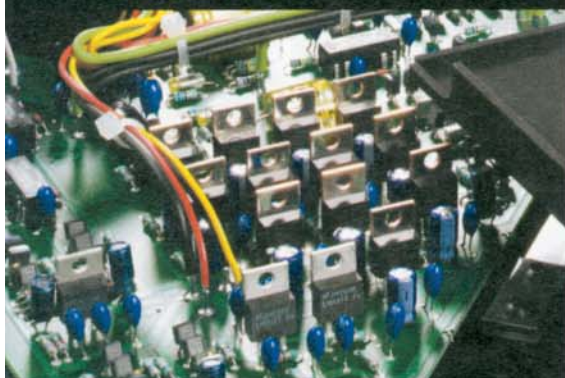
Halten die Versorgung der Baugruppen stabil: Heerscharen von Spannungsreglern.
