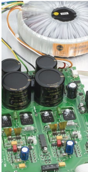
Ein Blick auf das Leistungsabteil des Verstärkers
