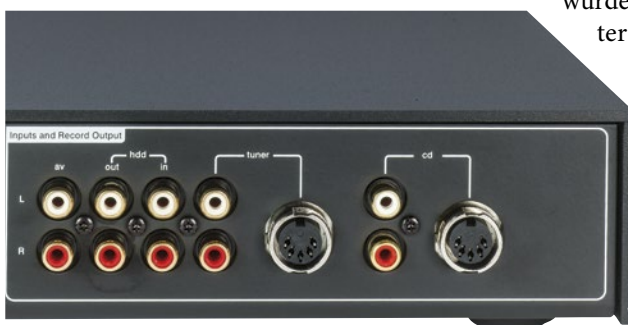
Federnd aufgehängtes Anschlussfeld inklusive zweier hochwertiger Din-Buchsen
