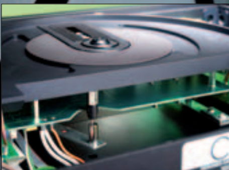
Ruht komplett auf Blattfedern: aus dem Vollen gearbeitetes Laufwerk des Naim.
