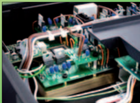
Sind auf Spiralfedern gelagert und mit reichlich Messing ruhiggestellt: Platinen des Naim.
