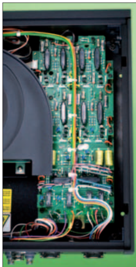
Wird mit einer eigenen Zuführung vom Netzteil versorgt: Platine fürs Analogsignal. Auf der unteren Etage sitzen die Spannungsregler.
