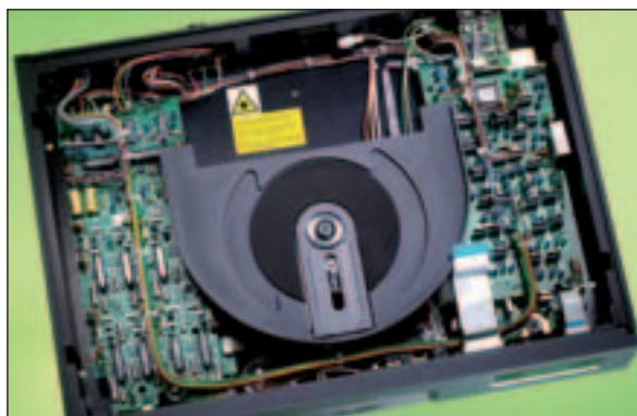
Sorgen für stabile Versorgung der Digital- (rechts) und Analogsektion (links): Insgesamt 63 Spannungsregler garantieren einen autonomen Stromhaushalt.
