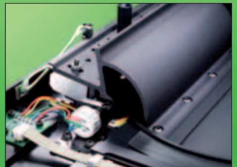
Jetzt mit Motorantrieb: schwere Klappe des Disc-Fachs aus einer Wolfram-Legierung.
