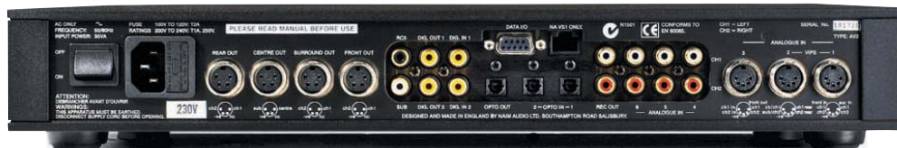
Alte Naim-Tradition: Auch der AV 2 hat DIN-Buchsen für einen Teil seiner Ein- und Ausgänge. Dank günstigerer Masseführung sollen sie besser klingen als ihre Cinch-Äquivalente.
