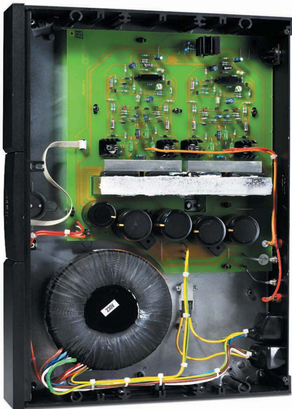
Kunsthandwerk: Wie alle Naim-Endstufen imponiert auch die dreikanalige NAP v 175 mit einem schönen Platinen-Layout und akkurat verlegten Kabelbäumen.
