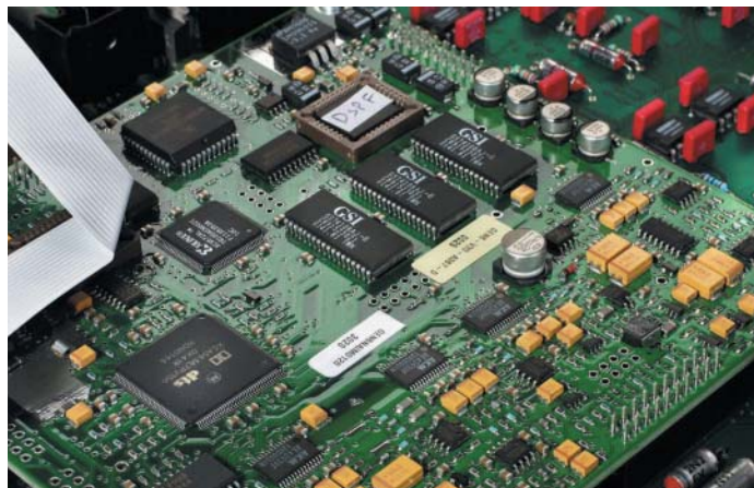
Digitales Herzstück des AV 2: Brandneuer Motorola-Decoder (links vorne) nebst Gefolge aus Speicher- und Logikchips. Als D/A-Wandler dienen die in besseren Surround-Kreisen beliebten Bausteine von AKM.
