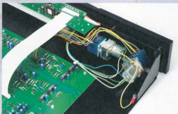
Under Cover: Der quer eingebaute motorgetriebene Balance-Regler der 202er lässt sich nur via Fernbedienung aktivieren.
