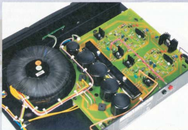
Schnell-Straßen: Die breiten, geschwungenen Leiterbahnen für guten Stromfluss (NAP 200) gehören seit Generationen zu Naim.
