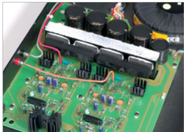
Der Transistoren-Schraubstock tut vermutlich der Mikrofonierresistenz und sicher der thermischen Ankopplung gut
