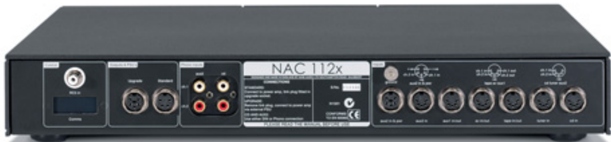
Multiroom mit Naim: Unter der RC5-Buchse ist Platz für die RS-232-Anschlüsse
