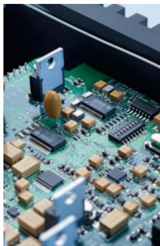
Links: Für kurze Signalwege verteilt sich die Elektronik auf mehreren Etagen. Mitte: Das Naim-eigene Streaming-Modul, auf das die Schotten stolz sind. Rechts: Leistungsbauteile müssen gekühlt werden.
