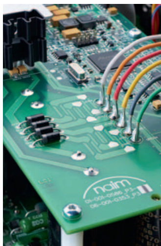
Links: Für kurze Signalwege verteilt sich die Elektronik auf mehreren Etagen. Mitte: Das Naim-eigene Streaming-Modul, auf das die Schotten stolz sind. Rechts: Leistungsbauteile müssen gekühlt werden.
