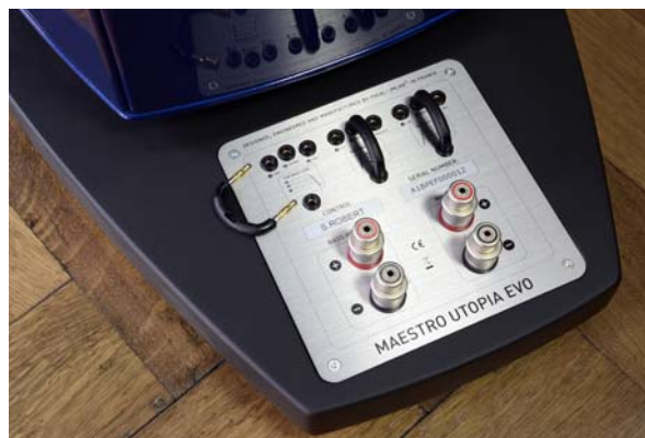
Bass, Mitten und Höhen lassen sich bei der Focal Maestro Utopia Evo per Steckbrücken justieren
