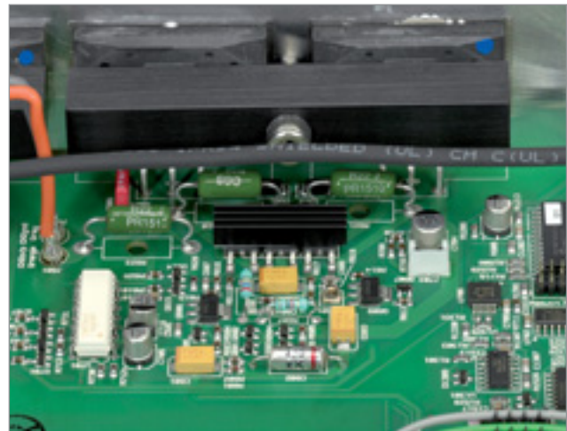
Vorbild SuperNait: Die Endstufensektion verlässt sich auch im XS auf eine komplementär-symmetrische Ausgangsstufe
