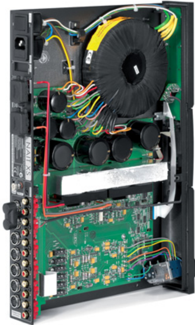
Sekundärwicklungen en masse: Der fette Ringkerntrafo ist eine Spezialanfertigung mit diversen voneinander unabhängigen Stromversorgungen
