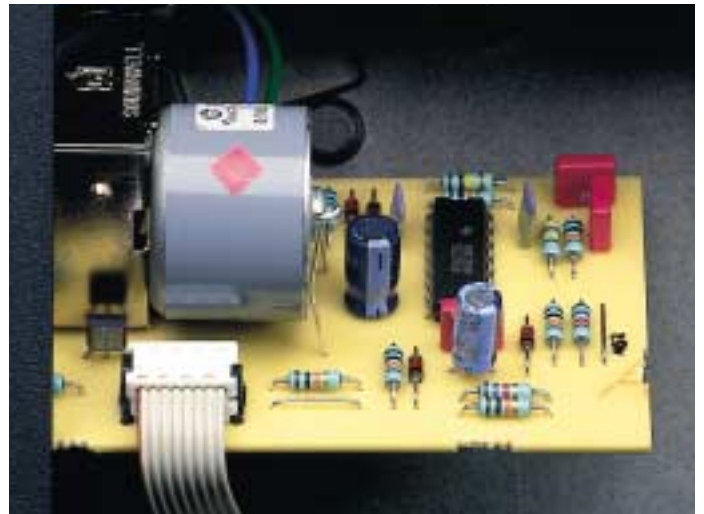
Von hier werden die Impulse des fernbedienbaren Lautstärke- stellers an die Schaltprozessoren weitergeleitet
